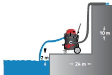
Lo schema mostra degli esempi di utilizzo dell'aspiraliquidi. Inoltre è indicata la possibile lunghezza della tubazione di scarico.
