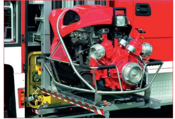
Absenkvorrichtung für optimale Ergonomie
